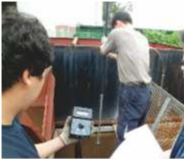
교반기 유속측정(신한펌프 공장내 시운전조)
