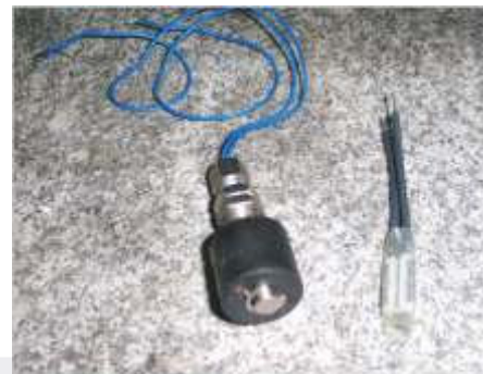
바이메탈 및 TP100Ω 온도센서 누수감지센서 (수중펌프의 모터/베어링/메커 자리에 설치한다)
